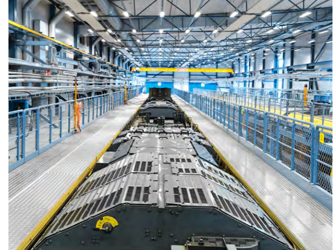
Ergonomisch: Die Dacharbeitsbühnen ermöglichen den bequemen Zugang zum Dachbereich bei allen Arten von Fahrzeugen.
