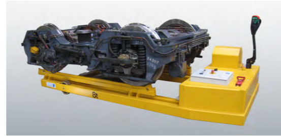
Transportfahrzeug: bewegt Lasten bis zu 50 Tonnen.
