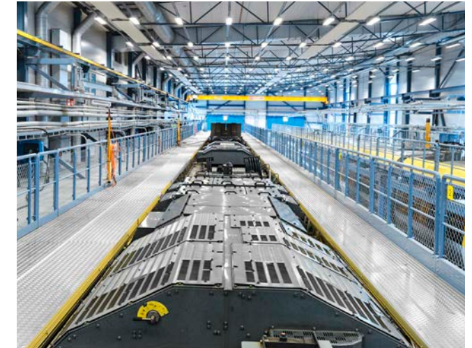
Ergonomiques: les passerelles de travail sur les toits offrent un accès commode aux toits des véhicules en tous genres.
