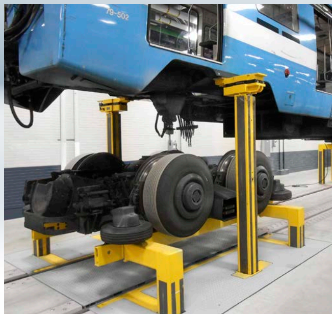
Flexibles: les installations de levage encastrées dans le sol permettent le remplacement de bogies, les travaux sur les véhicules et tous les travaux de contrôle.
