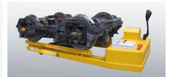
Véhicule de manutention: déplace les charges jusqu'à 50 tonnes.
